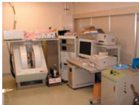
粉末試料の場合、標準の石英試料管に入れて測定するが、ゴニオメータ（一軸）による単結晶の測定、特殊セルを用いることによって水溶液の測定も可能である。
