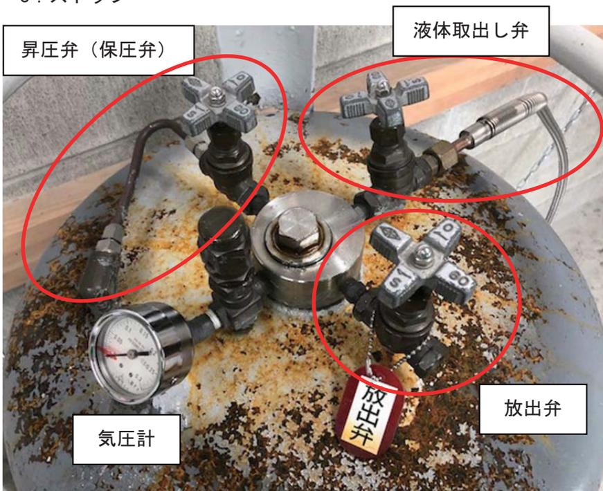
◎汲出し時に何か異変があった場合は、直ちに放出弁を開け、昇圧弁（保圧弁）を閉め、指導教員、または櫻井（内 3242）、船本（内 4572）に連絡して指示を仰ぐこと。
