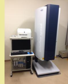
飛行時間型質量分析計 (TOF-MS)
