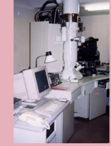
電界放射透過型電子顕微鏡 (FE-TEM)
