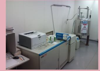
安定した磁場の中で、液体試料に電波を当てると試料中の水素や炭素等の原子核がその電波の特定の周波数に共鳴(振動)をするんだ(核磁気共鳴)。その周波数を調べるとCH<sub>2</sub>とかCH<sub>3</sub>、CH<sub>4</sub>などが試料の分子に含まれていることがわかるんだ。だから、安定した磁場を作るために超伝導磁石が使用されてるよ。
